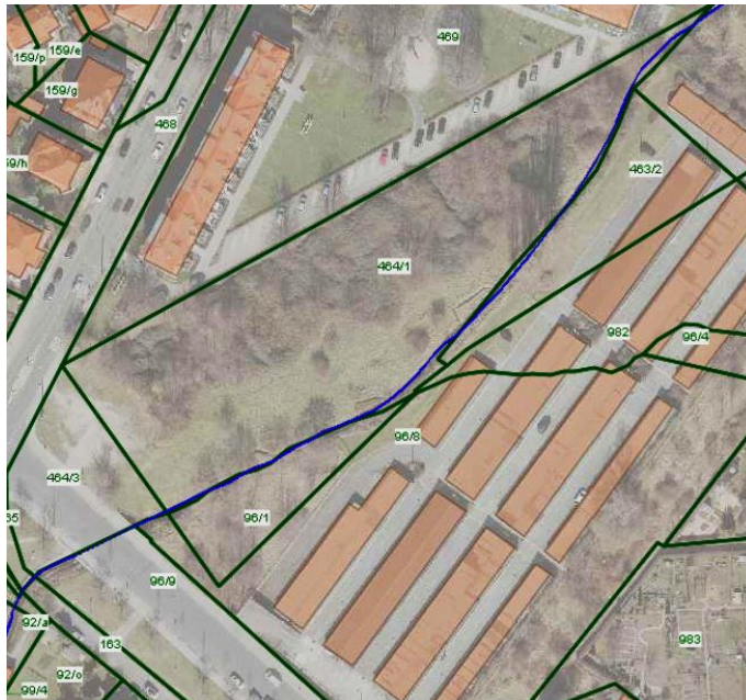
Bild 3.12 Nutzung des Flurstücks 464/1 als Hochwasserrückhaltebecken
